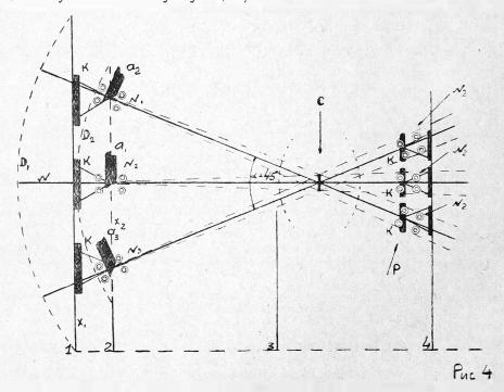
Скорость движения бленды с трубкой от 1 до 10 сек. на 1 метр се хода и регулируется передвижением шкивочка диаметром 120 мм по диску диаметра 250 мм. Диск находится на нижнем валу, а вал связан с бесконечными цепями посредством шестеренок (см. 13 на рис. 5).
