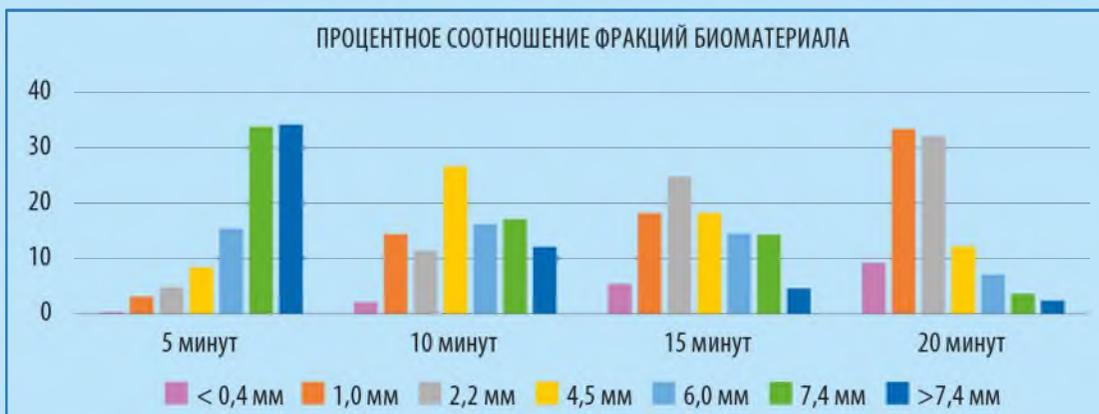
Рис. 2. Гранулометрический состав фракций, полученный при размоле соломы льна.
