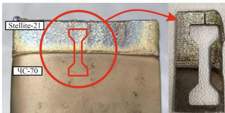
Рис. 6. Схема вырезки образцов для механического испытания.
